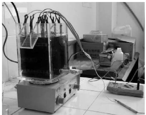
Hình 5. Hệ thí nghiệm keo tụ điện hóa trong phòng thí nghiệm
