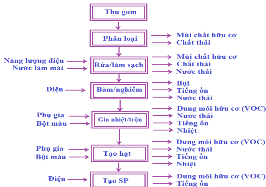
Hình 4. Quy trình sản xuất hạt nhựa cùng năng lượng và dòng thải
