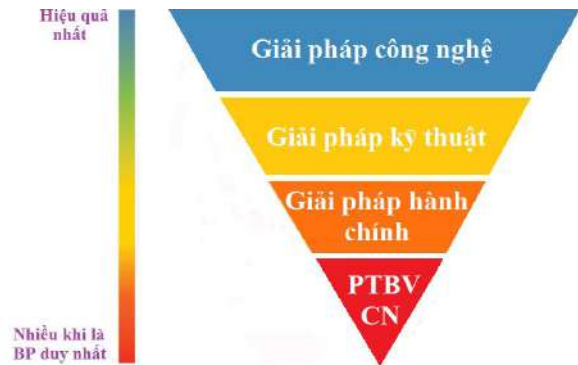
Hình 1. Hệ thống phân cấp kiểm soát
