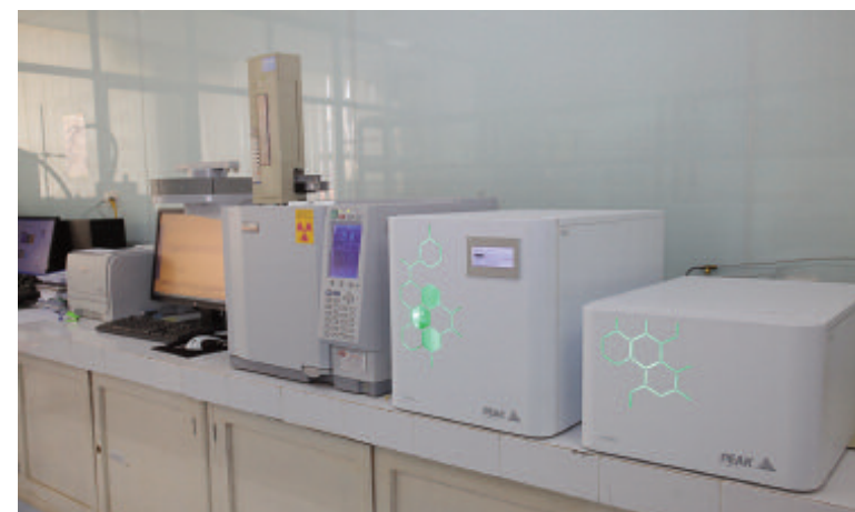
Hệ thống máy sắc ký khí GC 2010 Plus detector FID, FTD, FPD, ECD, TCD
