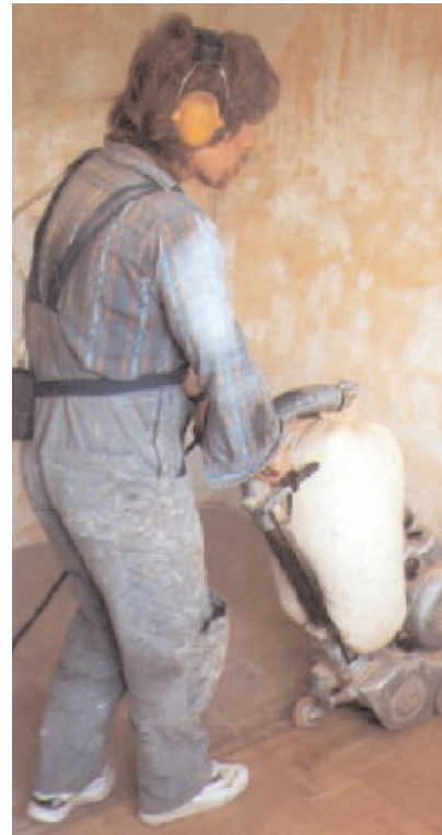
Ảnh 2: Mức độ phơi nhiễm bụi gỗ của một người được ghi lại bằng thiết bị đo bụi thời gian thực tế (DataRAM) trong suốt công đoạn mài ván sàn gỗ ở tư thế đứng. Đồng thời bụi cũng được lấy bằng thiết bị lấy mẫu bụi cá nhân (bơm gắn với bộ lọc cassette).
