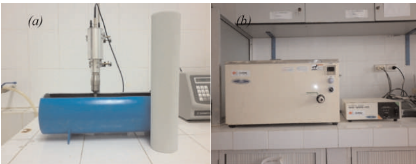
Hình 2. Súng siêu âm Ultraturrax – 750 (a) và Ultrasonic cleaner WS-1200-40 (b)
