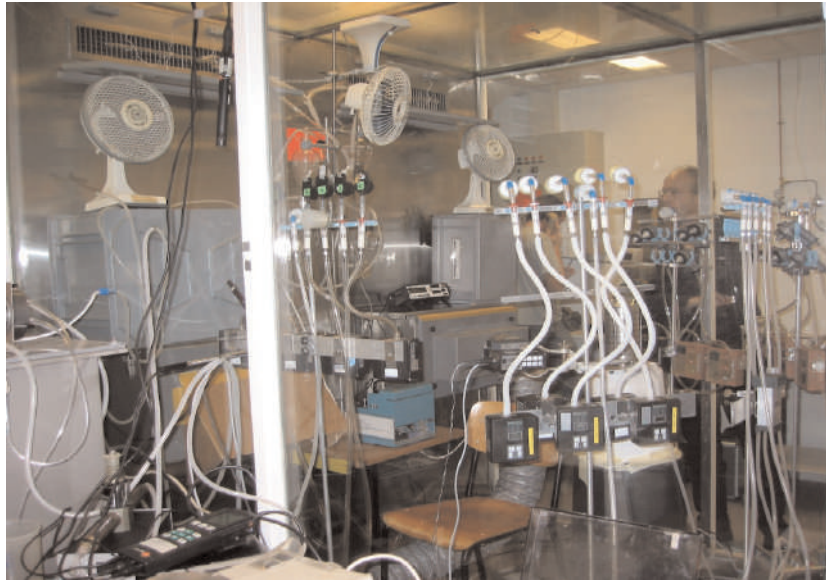
Hình 5: Hình ảnh của hàng loạt các thiết bị lấy mẫu trong khoang thí nghiệm 10m 3 , trong thời gian các phòng thí nghiệm thực hiện lấy mẫu. Sương dầu được tạo ra từ các loại dầu khoáng nhẹ, trung bình và nặng dùng trong luyện kim (Sommentor 29, Blaser VP1006 hoặc Blasomil 22 và Blaser 220) bằng máy xông khí chế tạo trong nước. Sương dầu tạo ra có thể điều chỉnh được trong khoảng từ 0,1 tới >20 mg/m 3 và có thể được giữ cố định với độ lệch chuẩn <5% trong vòng ít nhất 6 giờ. Tính đồng nhất không gian của sương dầu trong khoang thí nghiệm nằm trong khoảng 2-3% sau khi kiểm tra tại 5 điểm khác nhau. Mỗi đơn vị tham gia sử dụng từ 5 tới 6 đầu lấy mẫu để để có thể sử dụng vào các việc khác sau này.
