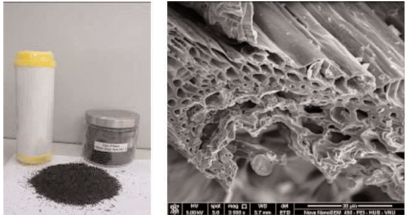
Hình 2. Lõi lọc và ảnh cấu trúc vật liệu lọc nước than hoạt tính từ trấu
