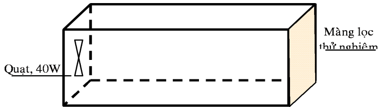
Hình 2. Bộ thử nghiệm khử trùng của màng lọc phủ nano bạc
