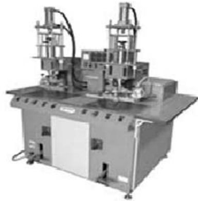
Hình 1. Máy dán ép cao tần sử dụng trong ngành giày da
