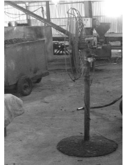
Hình 1. Loại quạt trục thường được dùng để thổi mát cục bộ - chống nóng
