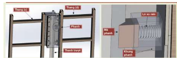
Hình 6. Vị trí phanh trên hệ thống thang thoát hiểm
