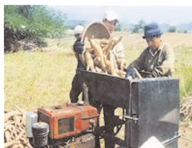
Hình 2. Máy cắt sắn do anh Thái (Phú Yên) chế tạo
