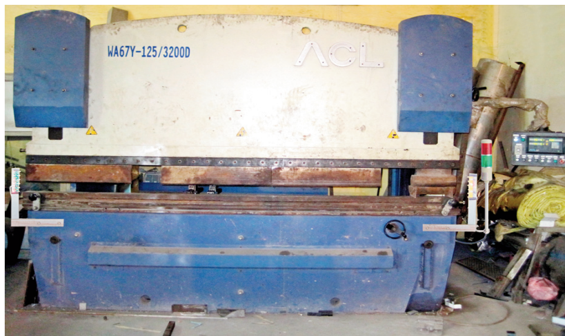
Hình 9. Thiết bị an toàn quang điện được ứng dụng thử nghiệm trên máy chấn tôn thủy lực ACL mã số WA67Y-125/32000
