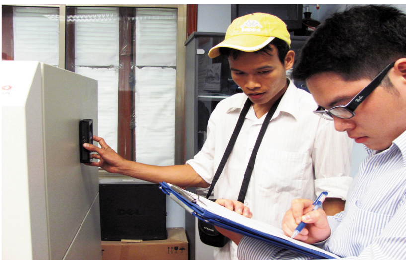
Hình 5. Đo suất liều bức xạ tại nhà máy xi măng Hải Phòng
