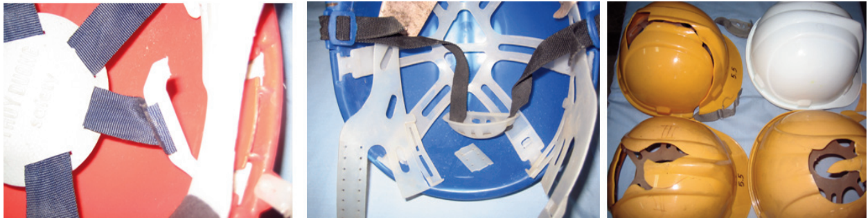
Ảnh 5. Mũ được đánh giá độ bền và đập giảm chấn sau khi phơi ngoài trời lần lượt là: TD, NQ, BB.
