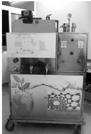
Ảnh 2: Thiết bị lọc nước 3 - 4 m 3 /h do Viện nước, tuyền tiêu và Môi trường sản xuất
