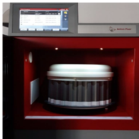
Hình 1. Sơ đồ và hình ảnh thiết bị vi sóng Multiwave PRO-16HF100-Áo
