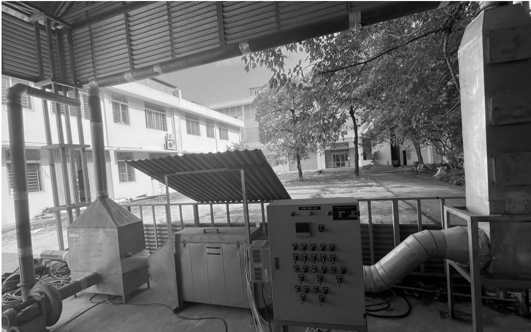
Pilot nghiên cứu thực nghiệm xử lý khí CO ở nhiệt độ thấp bằng xúc tác phủ trên bề mặt vật liệu mang Ceramic
