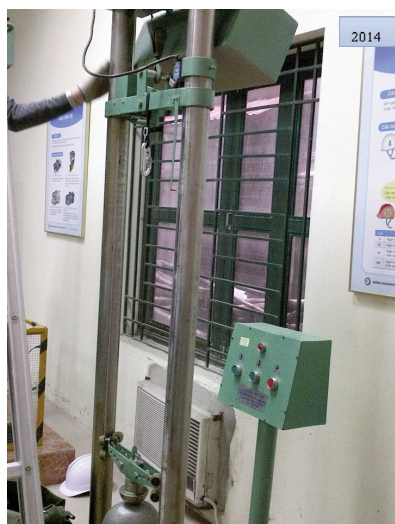
Hình 1. Thiết bị thử nghiệm độ giảm chấn, đâm xuyên của mũ An toàn công nghiệp năm 2007; năm 2014 và sau khi sửa chữa năm 2015
