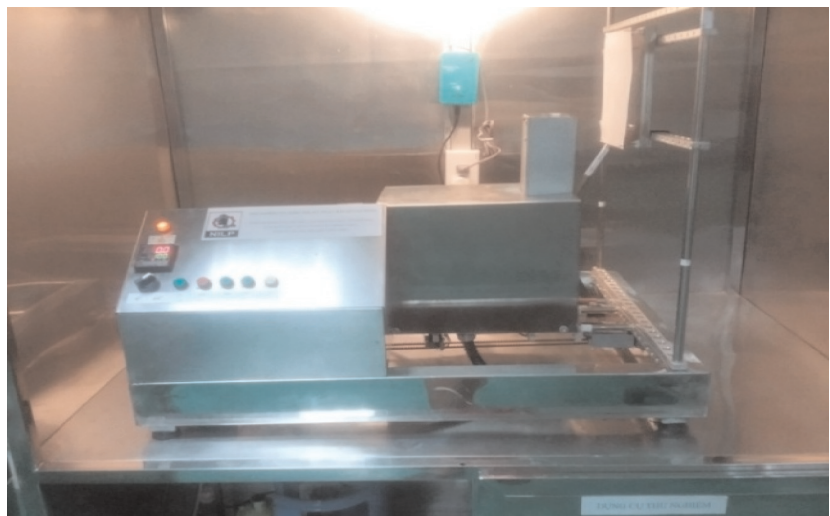
Ảnh 1: Thiết bị đánh giá chỉ tiêu lan truyền cháy có giới hạn của quần áo chống nóng và chống cháy
