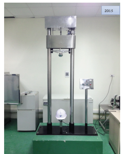
Hình 1. Thiết bị thử nghiệm độ giảm chấn, đâm xuyên của mũ An toàn công nghiệp năm 2007; năm 2014 và sau khi sửa chữa năm 2015
