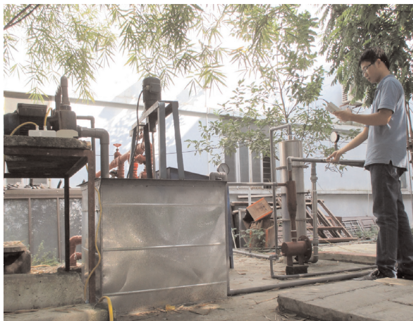
Hình 8: Đo kiểm các thông số kỹ thuật cho mô hình thử nghiệm thiết bị Xyclon thủy lực
