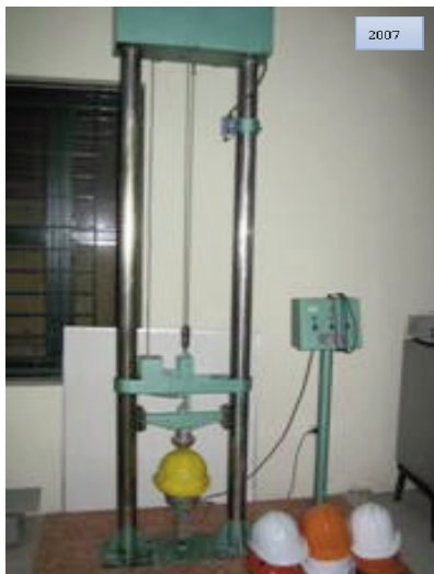
Hình 1. Thiết bị thử nghiệm độ giảm chấn, đâm xuyên của mũ An toàn công nghiệp năm 2007; năm 2014 và sau khi sửa chữa năm 2015
