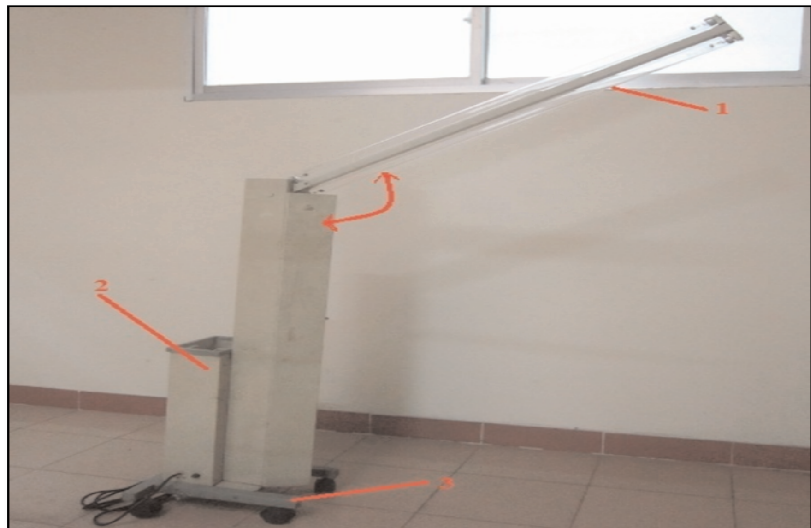
Hình 4. Thiết bị khử vi sinh vật chuồng trại sử dụng bức xạ UV 254nm
