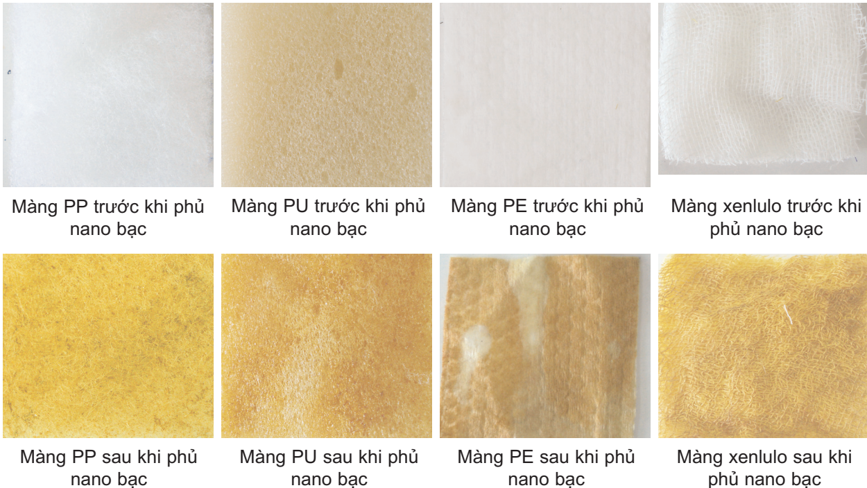
Hình 3. Hình ảnh các tấm màng trước và sau khi phủ nano bạc
