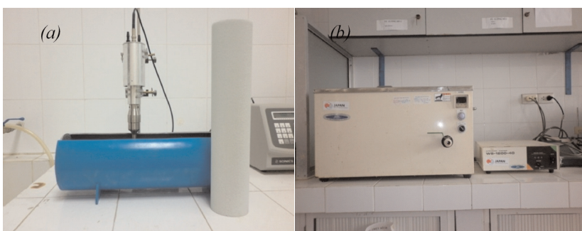
Hình 2. Súng siêu âm Ultraturrax – 750 (a) và Ultrasonic cleaner WS-1200-40 (b)
