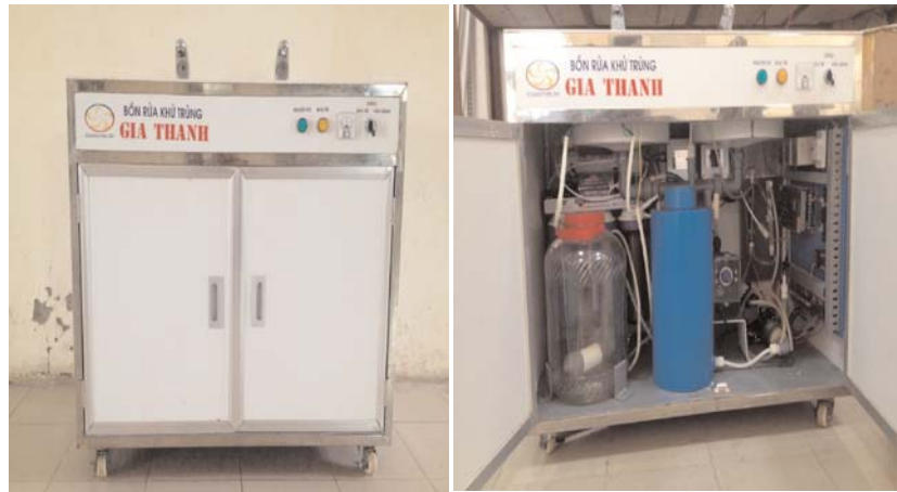
Hình 3. Hình ảnh bên ngoài (trái) và bên trong (phải) thiết bị Gia Thanh
