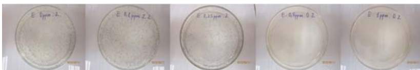
Hình 8. Hình ảnh mật độ vi khuẩn E. coli trên các đĩa petri sau khi cho tiếp xúc với dung dịch anolyte có nồng độ oxy hóa lần lượt là 0; 0,1; 0,25; 0,5; 1 ppm, trong thời gian 5 phút
