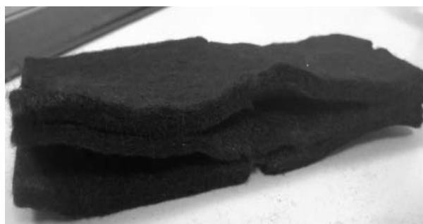
Hình 6. Điện cực vôi cacbon bị hỏng
