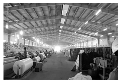
Ảnh 6: Máy dệt - có sử dụng nước
